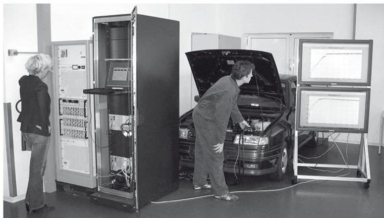
Abb. 2: Virtuelle Starterbatterie in den Laboratorien des IWES
