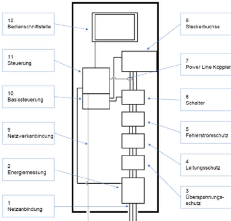
Abbildung 2 : Schematische Darstellung einer Ladestelle mit allen funktionalen Komponenten
